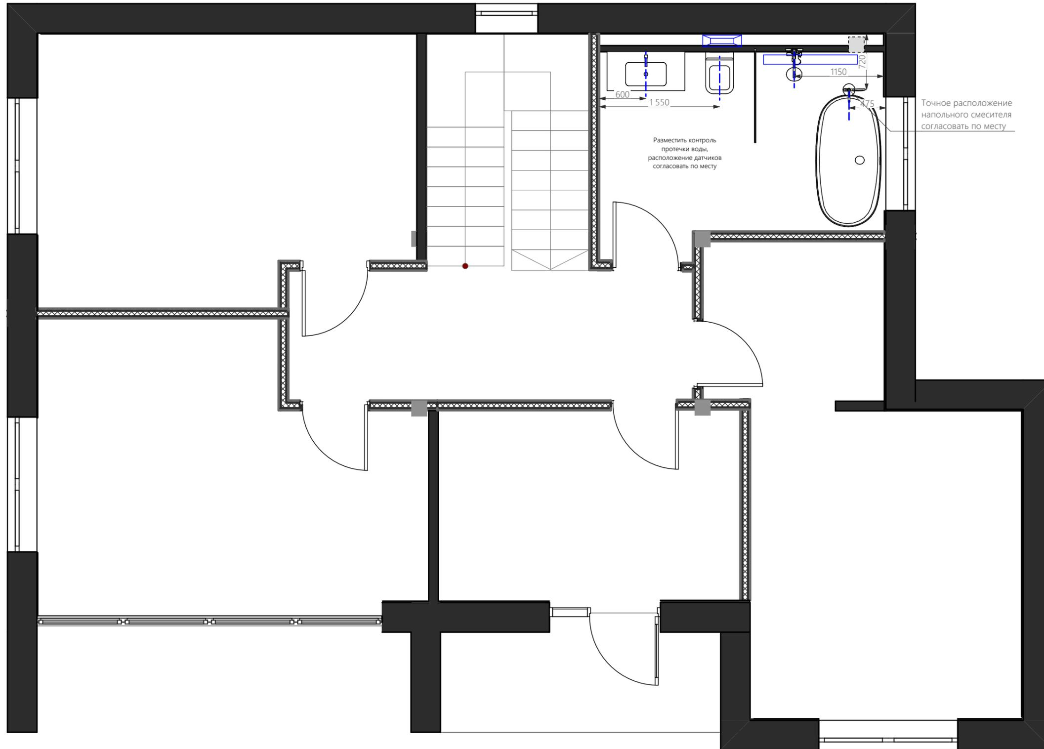
Разместить контроль протечки воды, расположение датчиков согласовать по месту
