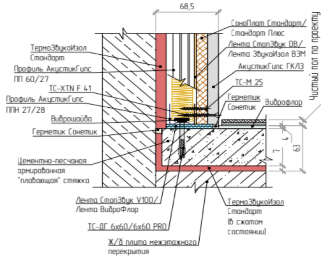
Схема звукоизоляции пола
