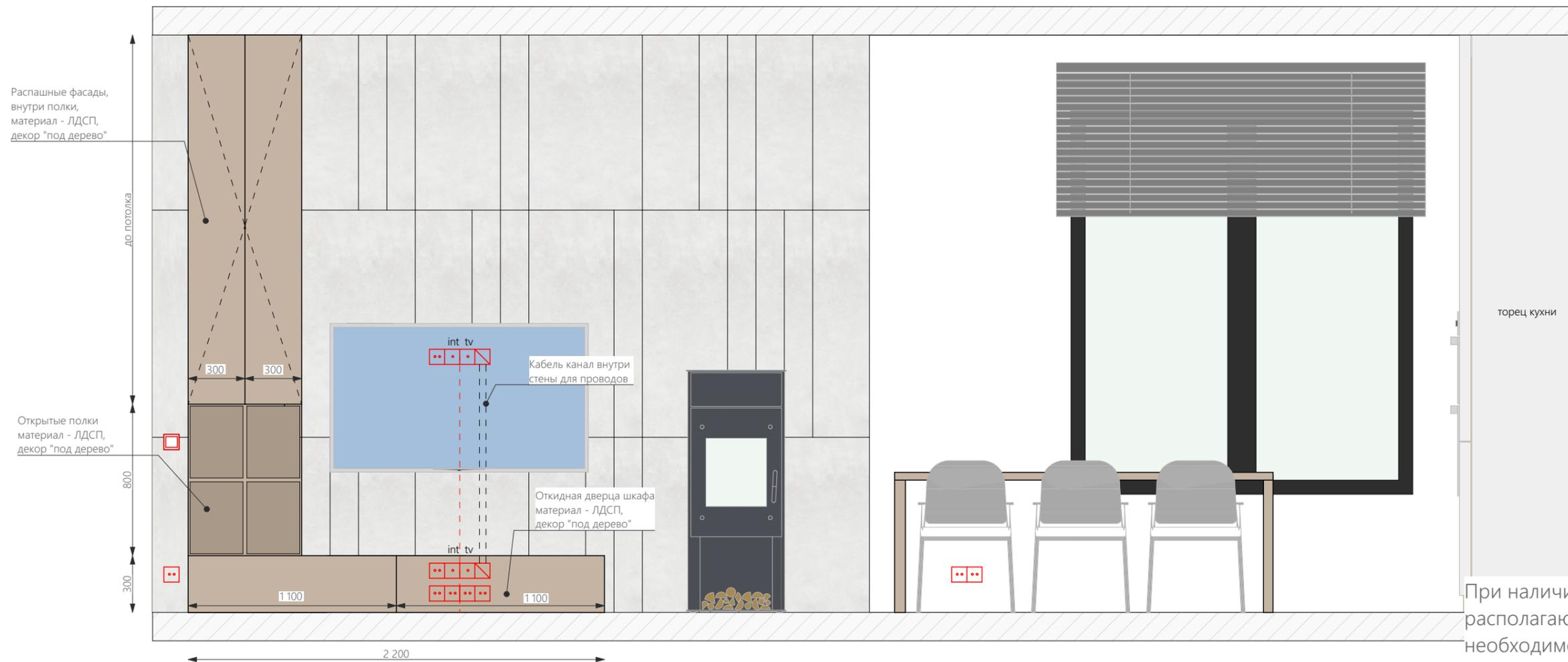
При наличии техники (колонки и тп), располагающейся на поверхности тумбы, необходимо предусмотреть открывающийся лючок в верхней части тумбы, для вывода проводов
